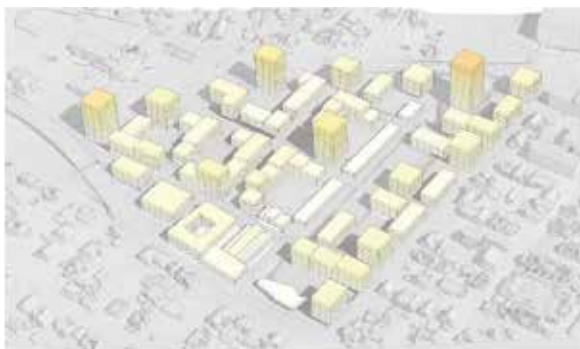
Lave kvartaler og høye punktbygg vist i en illustrasjon av byggehøyder - som kan tilpasses utbyggingsgrunn og økonomien i disse.
